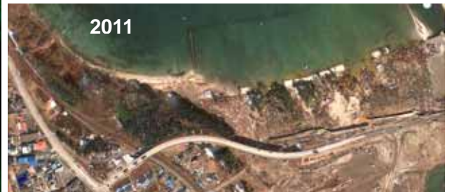
Fig. 18 海岸クロマツ林の前後にある二重の防潮堤も倒壊、地盤沈下も加わり、以前あった砂浜はほとんど消失(岩手県山田町船越浦)
